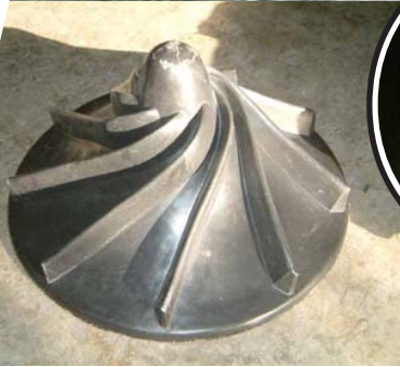
ใบพัดกวนเพื่อเพิ่มออกซิเจนในน้ำเสีย Oxygen refiller paddle
